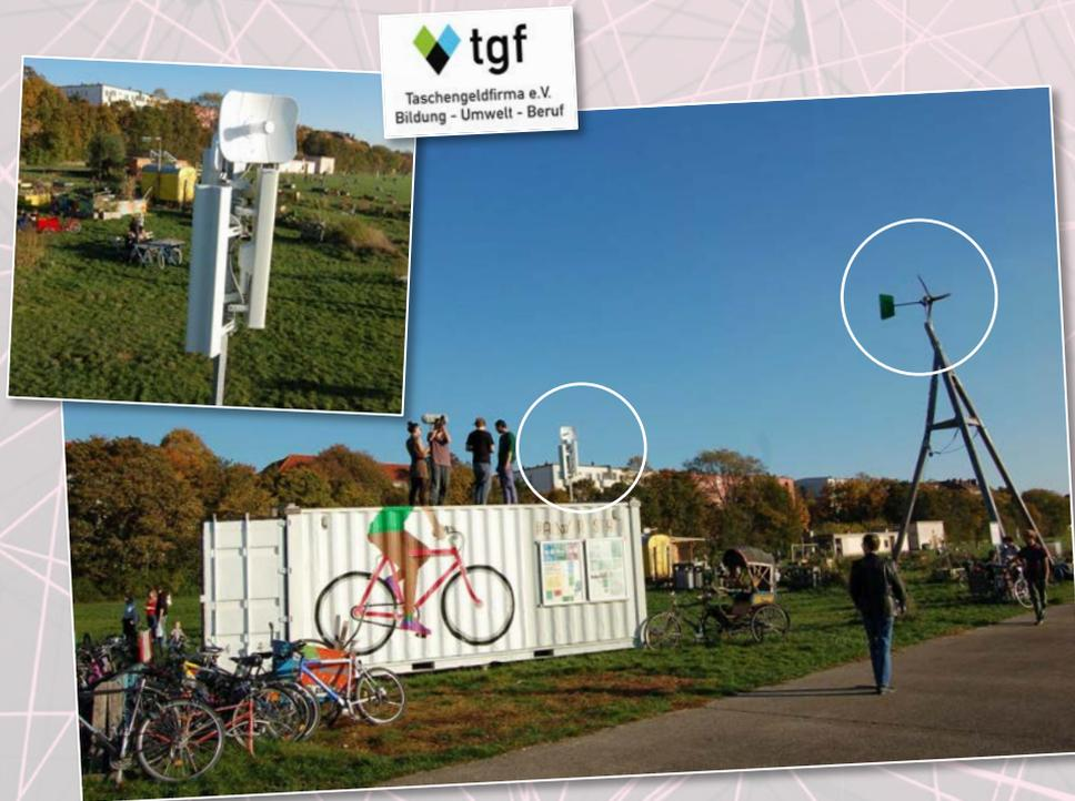
Das Windrad am Tempelhofer Feld versorgt Freifunk Router mit Strom, diese meshen mit dem Knoten am Tempelhofer Flughafen
